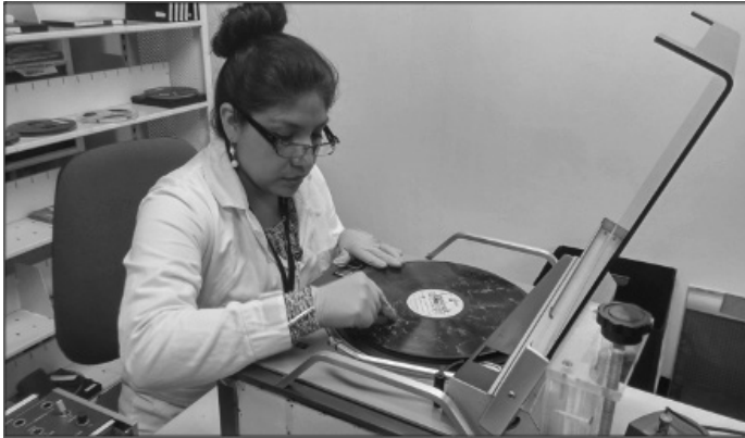
Foto 7. Conservadora realizando tratamiento de limpieza a causa del ácido palmítico
