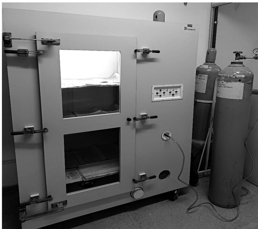
Figura 5. Câmara de desinfestação
