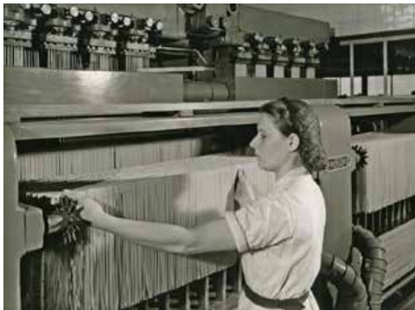
Figura 1. Fotografie | Fabrikation Teigwaren: Automatischer Nudeltrockner
